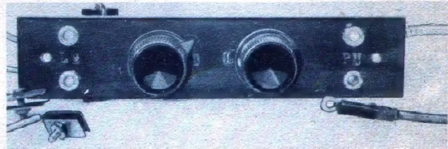
Das kleine Zusatzgerät von oben und von rückwärts gesehen. Rechts der Lautfärkeregler. Links die Tonblende.
